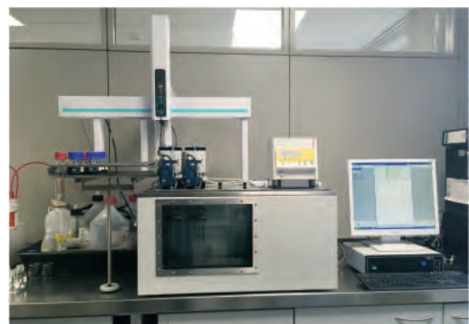
图6 溶液粘度：通过这种方法可以对交付的原材料质量和加工质量做出判断。为此，干燥的样品将放置在合适的溶液中进行溶解，测量通过毛细管的时间，并与所用溶剂做对比。
