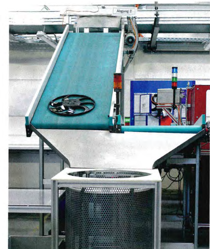
◀ Im Bild ein Abgang der Hochbandanlage: Die Lüfterräder landen in einer Puffertonne, werden anschließend verpackt und zu den Kunden versandt.
